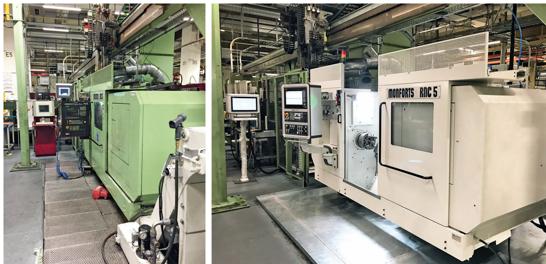
1 Aus betagt (links) mach modern (rechts): Die überholte Drehmaschine Monforts RNC 5 hat ihren angestammten Platz in der Prozesskette wieder eingenommen © HDC Huttelmaier
